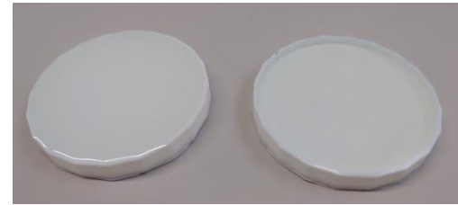
Right : Epoxy scintillator Left : +1w% LiF
