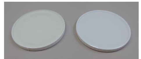
Right : Epoxy scintillator Left : +10w% PhB(OH) 2
